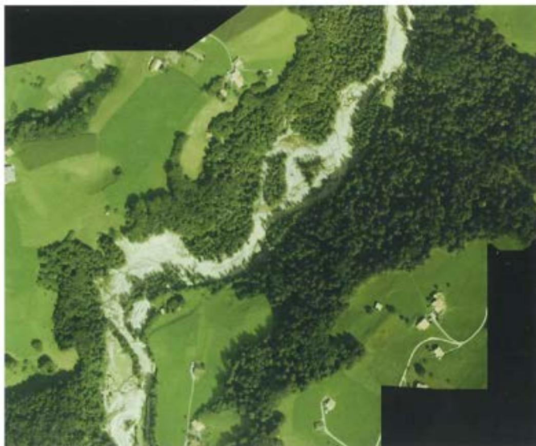
76'000 m<sup>3</sup>. Von diesen 190'000 m<sup>3</sup> Geschiebe gelangten knapp die Hälfte in die Kirel unterhalb Horboden. Das Geschiebe wurde durch Tiefen- und Seitenerosionen, aber auch durch Böschungsrutschungen mobilisiert. Erosive Phasen wechselten immer wieder mit Auflandungsphasen ab.
